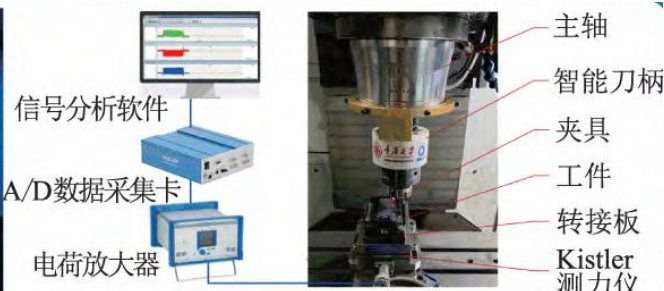
分体式智能刀柄铣削测试
